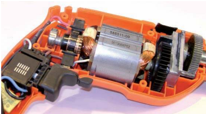
Fig. 11.31. Motor monofásico universal para un taladro eléctrico.
